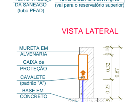
DETALHE - HIDRÔMETRO esc.: 1/25
