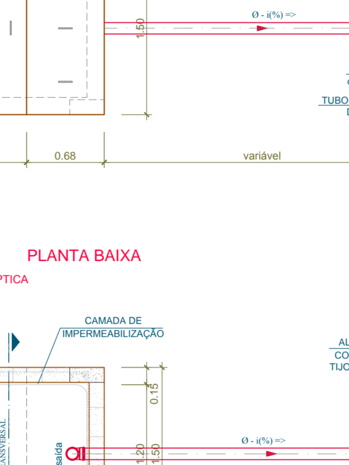
DETALHE - POÇO de INFILTRAÇÃO esc.: 1/33
