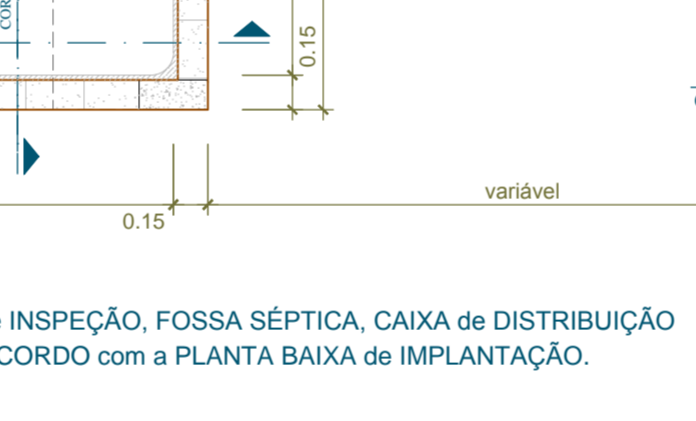
DETALHE - TANQUE SÉPTICO e SUMIDOURO(S) esc.: 1/33
