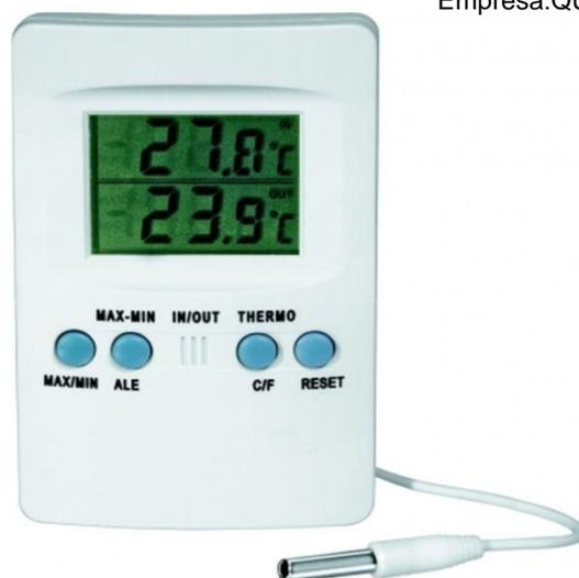
Termômetro digital de máxima e mínima próprio para medições simultâneas de temperatura interna (câmaras de refrigeração, etc.) e temperatura externa (ambientes).
