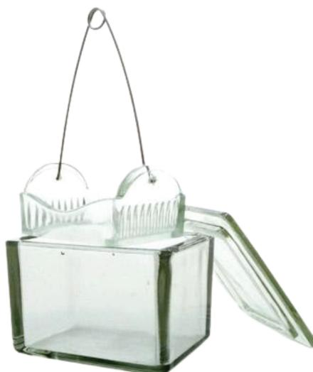
Utilizada em diversos protocolos de Análises Clínicas sendo ideal para o processo de coloração de lâminas. Com tampa de vidro. Autoclavável a 121°C. Para 8 Lâminas 76 x 26 mm
